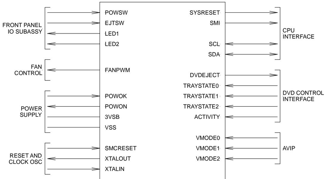
**Figure 17. SMC IO Diagram**
